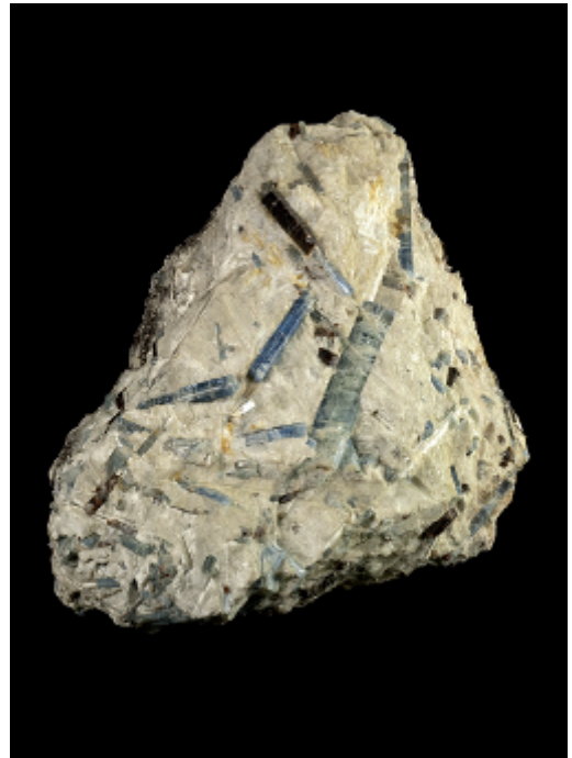
Échantillon de roche métamorphique, mica schiste à paragonite avec staurolite (brun) et cyanite (bleu) de l'Alpe Sponda (Pizzo Forno, Tessin, Suisse).
