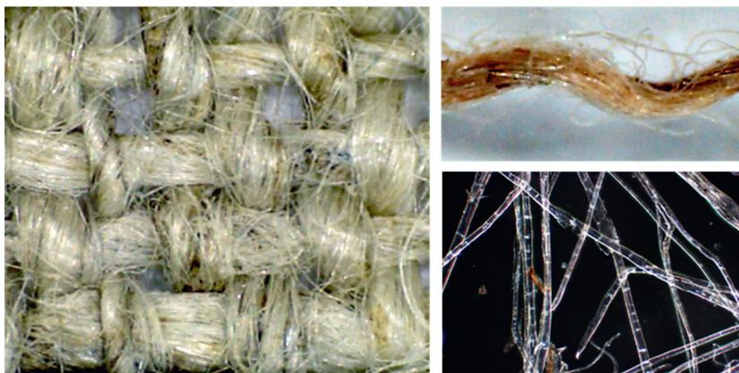
*Figure 8: Structure des fibres de lin.*
